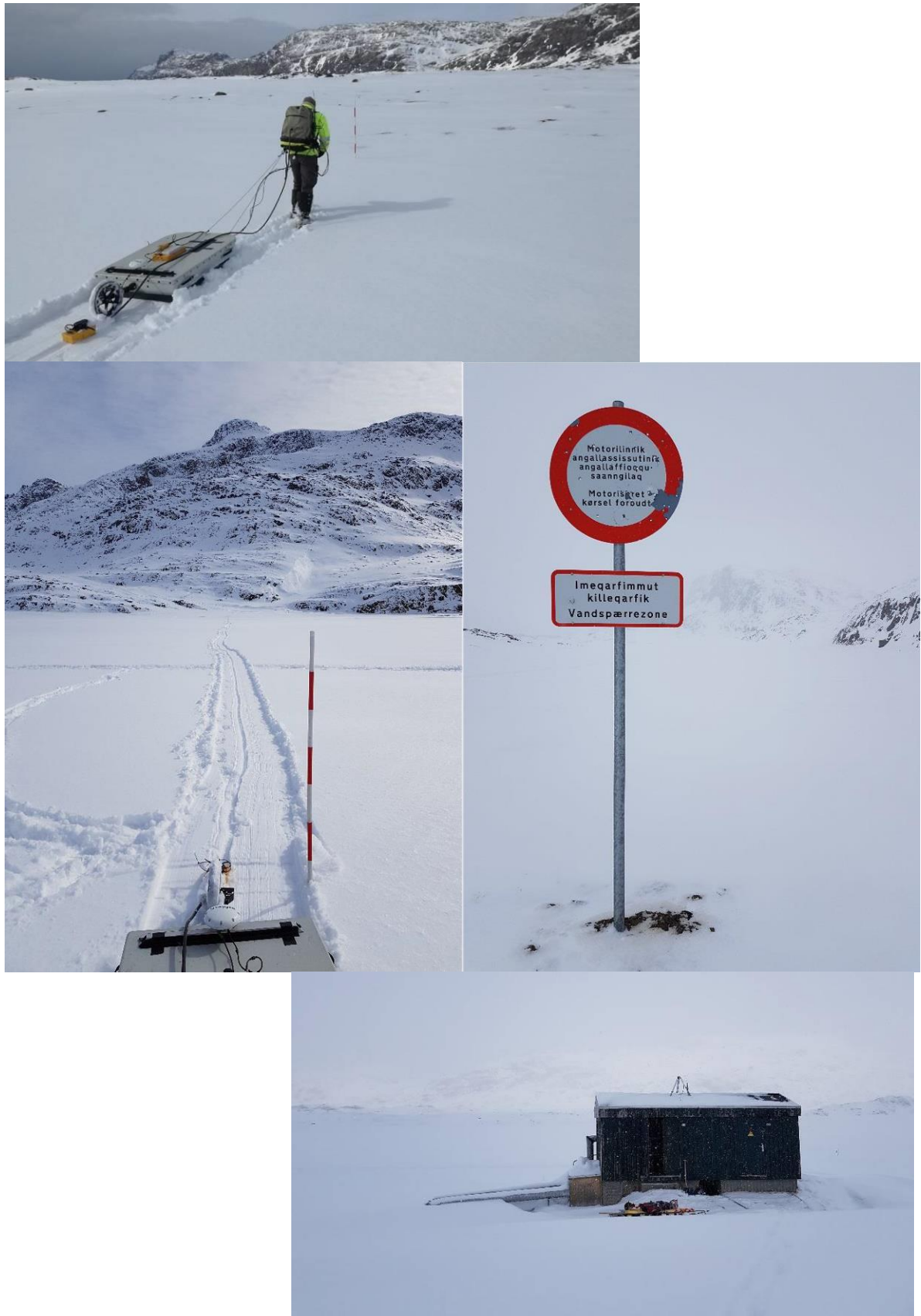
Figur 2. 100 MHz samt 1.2 GHz antenne bliver trukket over isen (øverst og midten til venstre). Vandspærrezone er nået (midten til højre). Pumpehuset som fungerede som base - både for feltfolk og udstyr.
